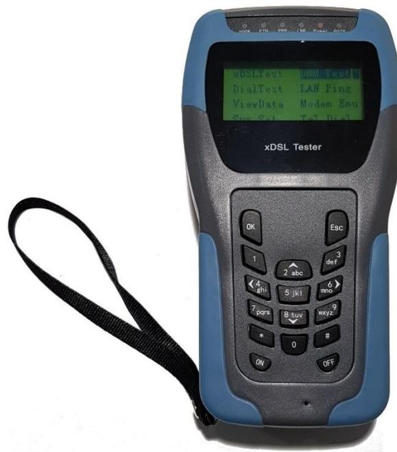
Analyseur xDSL multifonctions conçu pour l'activation et la maintenance des lignes ADSL, ADSL2, ADSL2 +, READSL, VDSL2
